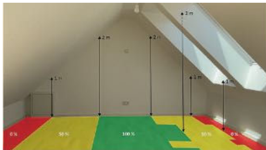
Abb. 1 + 2: Anrechnung von Grundflächen unter Dachschrägen
